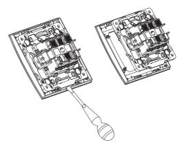
Снять клавишу, путем ее легкого поднятия наконечником плоской отвертки.
