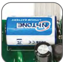
Часы реального времени работают 10 лет без питания
