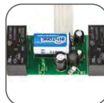
Два встроенных реле на токи до 16 А
