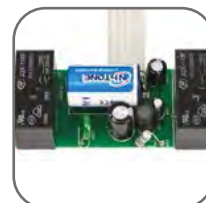
Два встроенных реле на токи до 16 А
