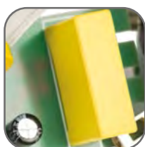
Дополнительный релейный выход для сигнализации
