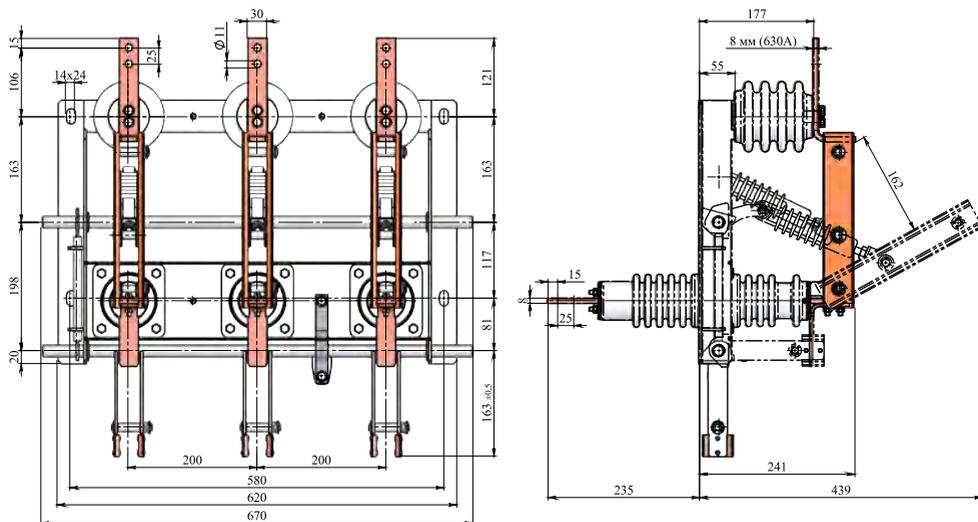
Рисунок 1 – Габаритные размеры РВФ3-10/630-II-II УХЛ3 EKF Stingray
