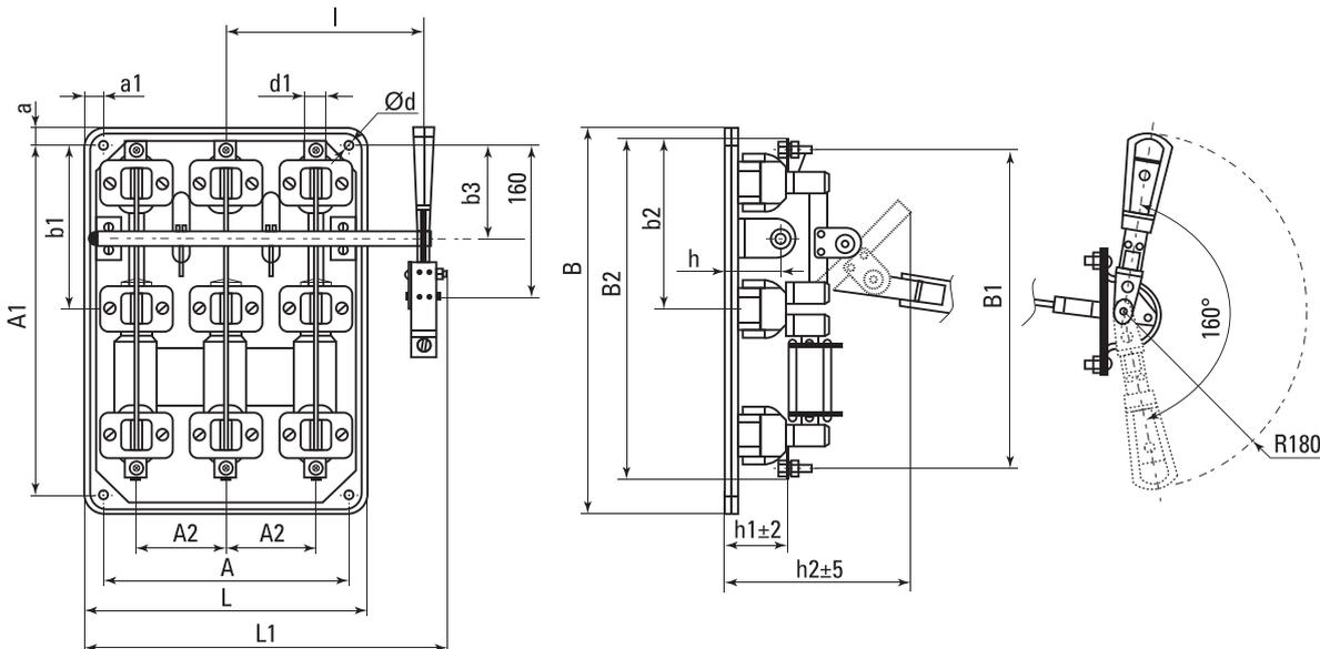
Рис.2 Габаритные и установочные размеры разъединителя типа РПС
