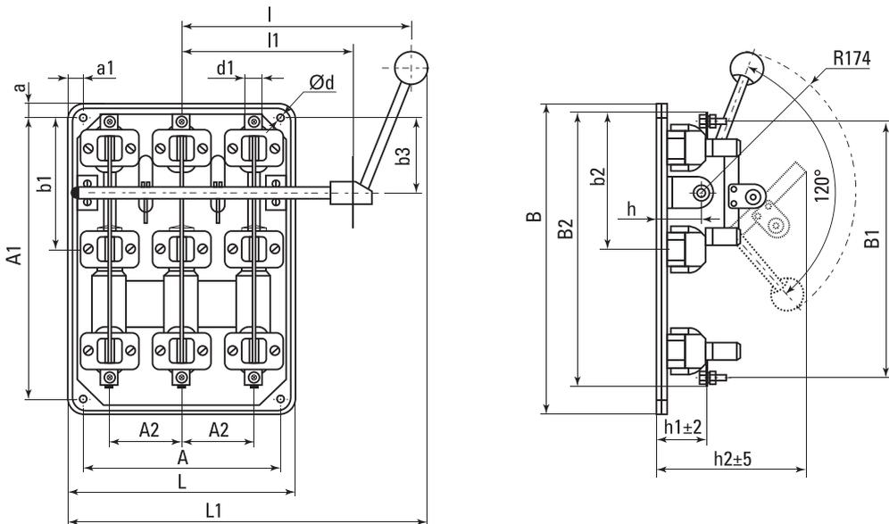
Рис.1 Габаритные и установочные размеры разъединителя типа РПБ
