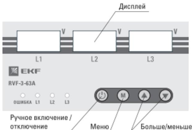
Рисунок 4 Дисплей и индикация
