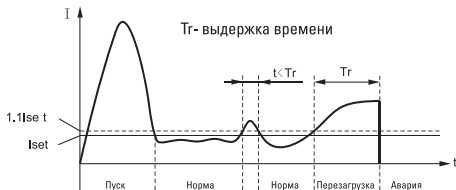
Рис. 5 Диаграмма работы реле при перегрузке
