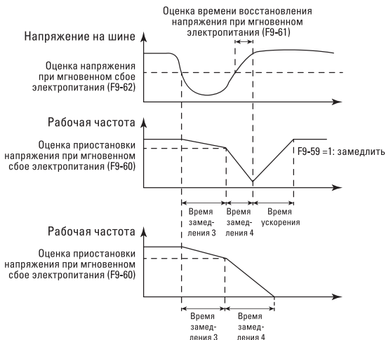
Рис. 6-25. Схема действия при мгновенном сбое электропитания
