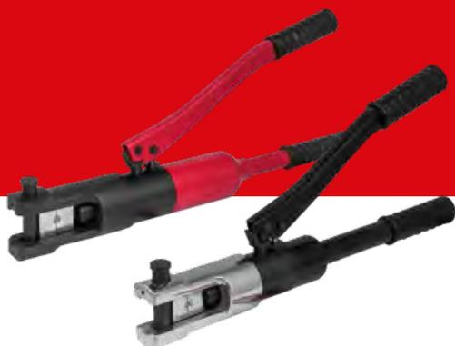
Прессы гидравлические EKF серий MASTER и EXPERT предназначены для быстрой и качественной опрессовки медных и алюминиевых кабельных наконечников и гильз, выполненных по стандарту ГОСТ и DIN, с помощью гидравлического мультипликатора.
