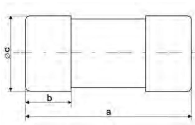
Рис. 1 Габаритные размеры плавких вставок ПВХ
