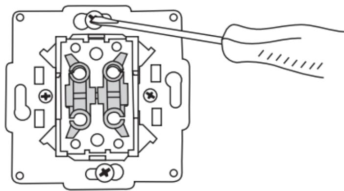
Установить механизм изделия в углублении стены, зафиксировать стопорные винты, затянув их до упора.
