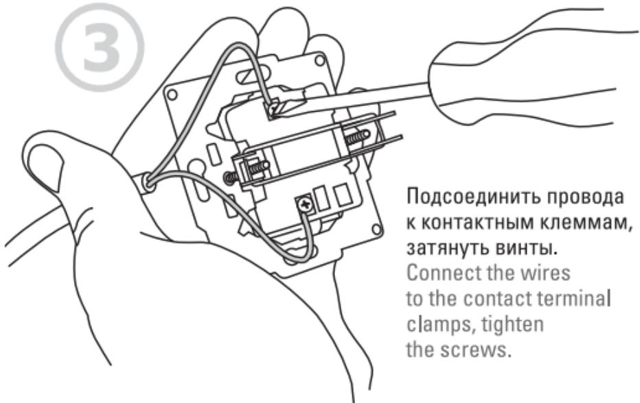
Подсоединить провода к контактным клеммам, затянуть винты.
