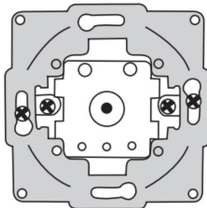
Установить механизм изделия в углубление стены, зафиксировав стопорные и крепежные винты на корпусе изделия. Затянуть винты до упора.
