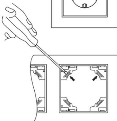
Для беспрепятственной установки на механизм 2/3/4-местной рамки – удалить выделенные элементы рамки вручную, плоской отверткой или кусачками.
