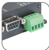
Стандартные интерфейсы RS485 и RS232
