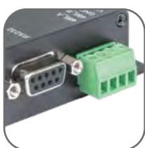
Стандартные интерфейсы RS485 и RS232
