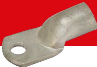
Силовые наконечники EKF PROxima используются для оконцевания проводов и кабелей с медными жилами посредством опрессовки для последующего болтового соединения проводника с оборудованием или шиной. Наконечники изготавливаются из медных и алюминиевых труб различного диаметра.
