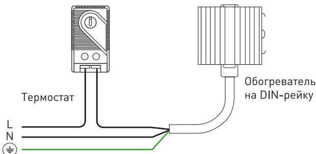
Используемый нагревательный элемент позистор (PTC) не требует защиты от перегрева нагревателя, но не заменяет применение термостата для регулирования температуры воздуха. Термостат приобретается отдельно. Установка прибора на DIN-рейку в вертикальном положении. Для обеспечения свободной циркуляции воздуха необходим зазор между радиатором нагревателя и установленным оборудованием или проводкой не менее 50 мм. Обогреватели, имеющие внешние механические повреждения, эксплуатировать запрещено.
