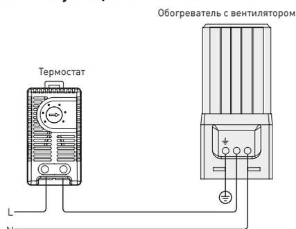
Монтаж и подключение обогревателя должны осуществляться квалифицированным электротехническим персоналом. Монтаж на 35 мм DIN-рейку. Для защиты от перегрева необходимо подключение через термостат.
