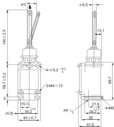
Рис. 9 Габаритные размеры концевого выключателя WLNJ EKF PROxima
