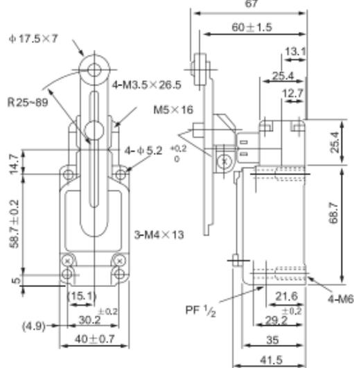
Рис. 2 Габаритные размеры концевых выключателя WLCA12-2-Q EKF PROxima
