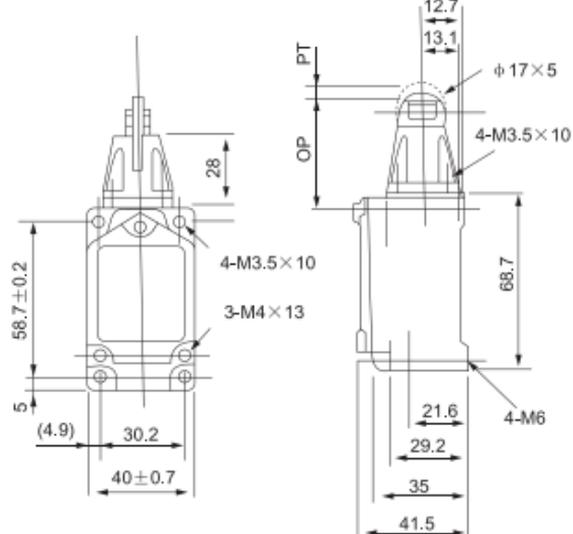
Рис. 6 Габаритные размеры концевого выключателя WLD1 EKF PROxima
