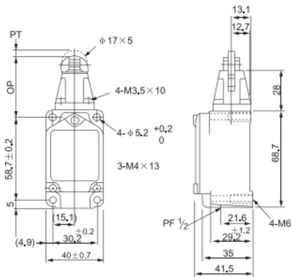
Рис. 7 Габаритные размеры концевого выключателя WLD2 EKF PROxima
