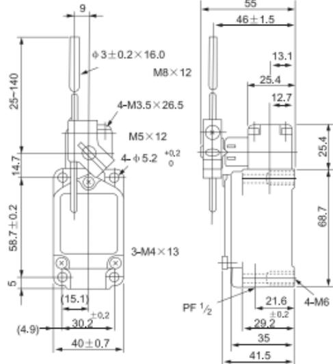
Рис. 4 Габаритные размеры концевых выключателя WLCL EKF PROxima
