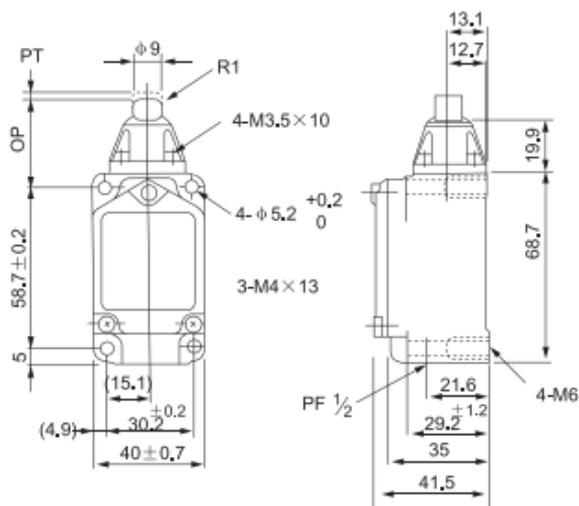
Рис. 5 Габаритные размеры концевых выключателя WLD EKF PROxima
