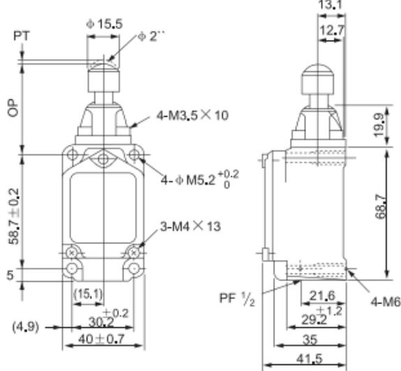
Рис. 8 Габаритные размеры концевого выключателя WLD3 EKF PROxima
