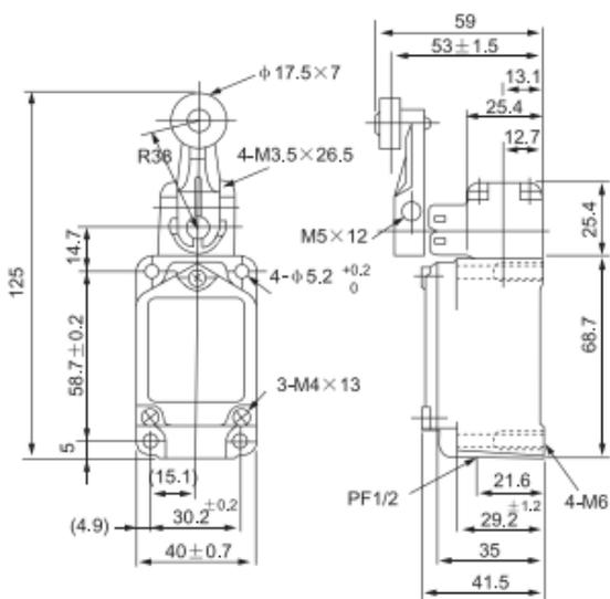
Рис. 1 Габаритные размеры концевого выключателя WLCA2-2 EKF PROxima
