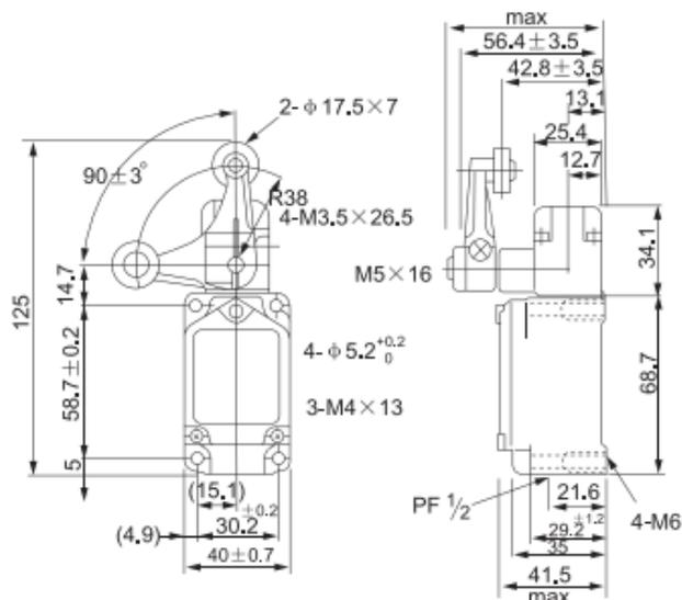
Рис. 3 Габаритные размеры концевых выключателя WLCA32-41 EKF PROxima
