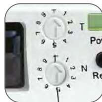
Регулировка количества взведений и время, через которое будут происходить
