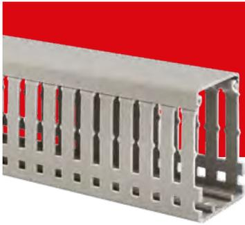
Используются внутри шкафов для формирования внутренних кабельных трасс. Наличие перфорации позволяет осуществлять легкий подвод кабелей к оборудованию, обеспечивает естественную вентиляцию и простое обслуживание сформированной трассы. Кабельные каналы (кабельные короба, электрокороба) представляют собой профили прямоугольного сечения
