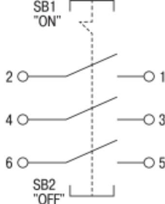
Рис.1 Электрическая схема
