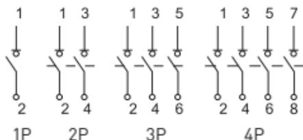
Рис. 1 Типовые схемы подключения
