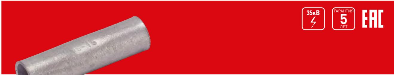
Гильзы алюминиевые EKF PROxima изготавливаются из цельнотянутой алюминиевой трубы марки АД1 и имеют сквозную конструкцию. При соединении посредством гильз секторные жилы перед опрессовкой должны быть предварительно скруглены.
