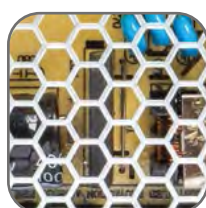
Вентиляционные отверстия для лучшего теплоотвода
