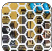
Вентиляционные отверстия для лучшего теплоотвода
