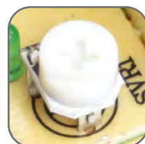
Возможность корректировки выходного напряжения
