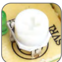
Возможность корректировки выходного напряжения
