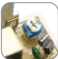
Возможность корректировки выходного напряжения
