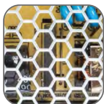
Вентиляционные отверстия для лучшего теплоотвода
