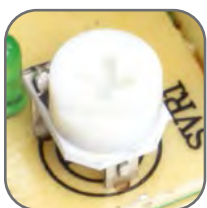
Возможность корректировки выходного напряжения
