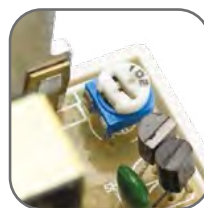
Возможность корректировки выходного напряжения
