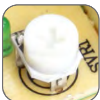
Возможность корректировки выходного напряжения
