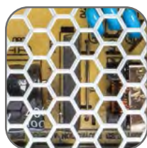
Вентиляционные отверстия для лучшего теплоотвода
