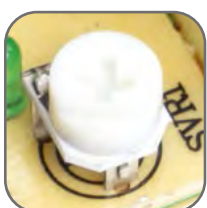
Возможность корректировки выходного напряжения
