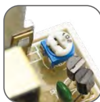
Возможность корректировки выходного напряжения
