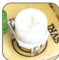
Возможность корректировки выходного напряжения
