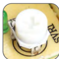
Возможность корректировки выходного напряжения
