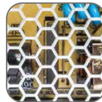
Вентиляционные отверстия для лучшего теплоотвода
