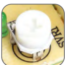
Возможность корректировки выходного напряжения
