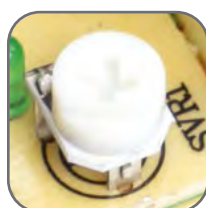
Возможность корректировки выходного напряжения
