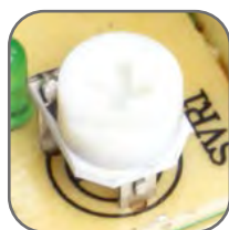
Возможность корректировки выходного напряжения
