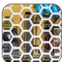
Вентиляционные отверстия для лучшего теплоотвода
