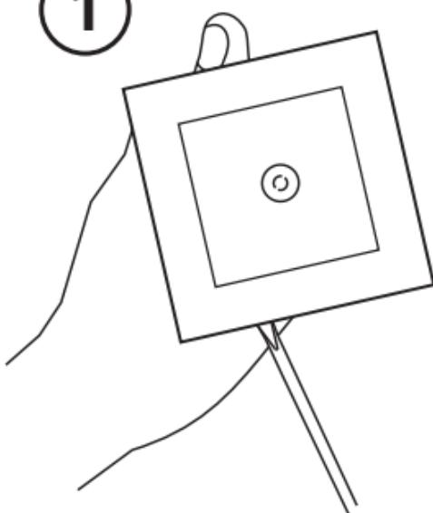
Снять внутреннюю часть лицевой части розетки, путем легкого отжатия наконечником плоской отвертки металлической части и декоративной рамки.
