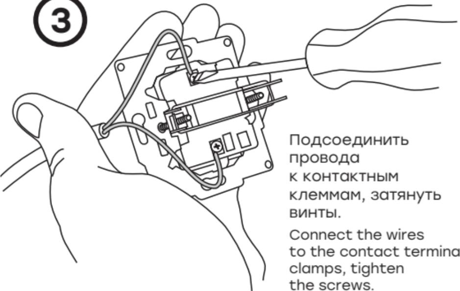
Подсоединить провода к контактным клеммам, затянуть винты.
