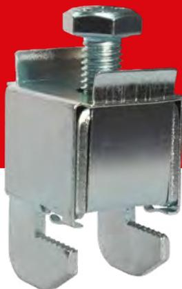
Универсальные терминалы для проводников EKF PROxima предназначены для присоединения и подключения проводников различных сечений (от 1 до 185 мм<sup>2</sup>) к плоским медным и алюминиевым шинам. Терминалы изготовлены из оцинкованной стали, устойчивой к перепадам температур и воздействию влаги.
