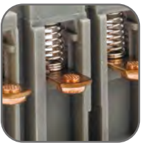
Самопозиционирующиеся подвижные контакты. Они могут качаться, подпружинены и имеют сферическую поверхность. Возможна коммутация алюминиевым и медным проводником
