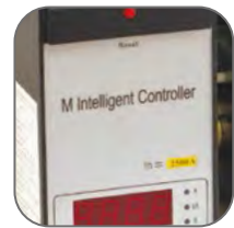
Микропроцессорный расцепитель с селективной программируемой защитой
