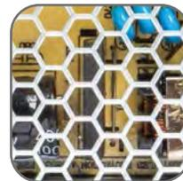
Вентиляционные отверстия для лучшего теплоотвода
