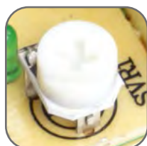
Возможность корректировки выходного напряжения
