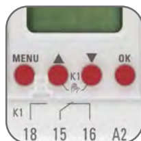
Ручное управление реле
