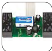
Два встроенных реле на токи до 16 А
