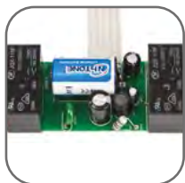
Два встроенных реле на токи до 8 А
