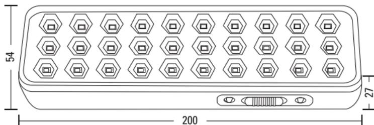
Рис. 1. Габаритные и установочные размеры BACKUP-150
