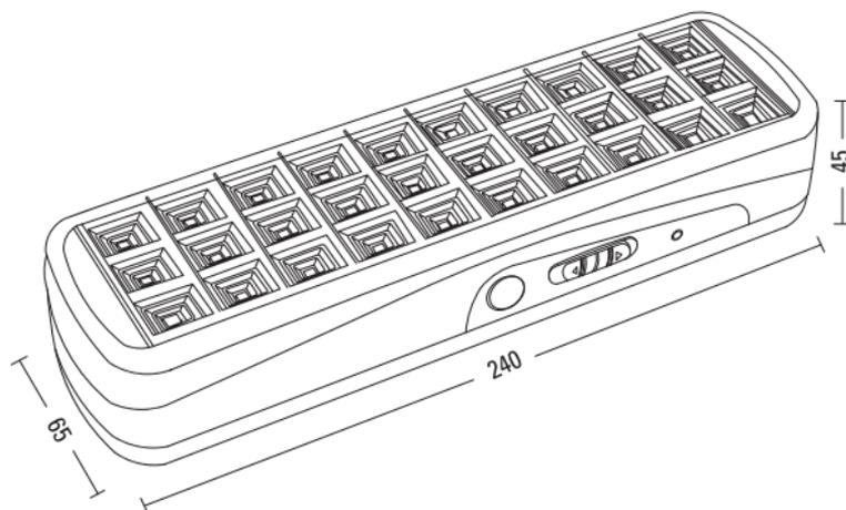
Рис. 2. Габаритные и установочные размеры BACKUP-250 / 250P
