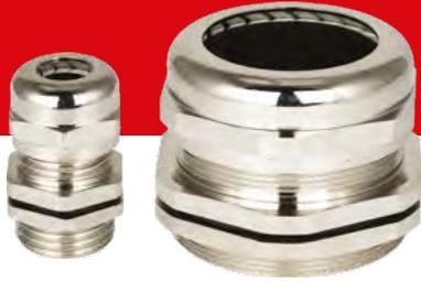
Сальники металлические MGM EKF PROxima состоят из стопорной гайки, корпуса, уплотнительной гайки (выполненных их никелированной латуни), зубчатой муфты (нейлон), уплотнителя (неопрен) и круглого уплотнительного кольца. Применяются в комплексных оболочках для достижения степени защиты IP68. Рекомендуются к применению при организации кабельного ввода в шкафах из нержавеющей стали или окрашенного металла.
