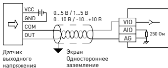
Рисунок 5 – Подключение аналоговых входов (входной сигнал – напряжение)
