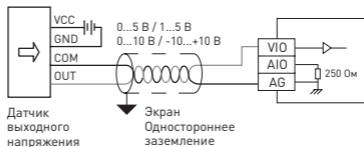
Рисунок 5 – Подключение аналоговых входов (входной сигнал – напряжение)
