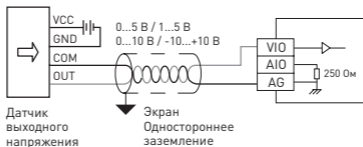
Рисунок 5 – Подключение аналоговых входов (входной сигнал – напряжение)
