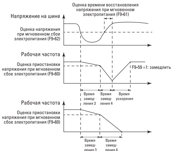
Рис. 6-25. Схема действия при мгновенном сбое электропитания
