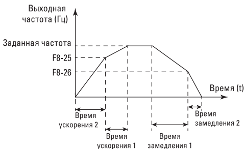
Рис. 6-19. Схема переключения времени ускорения/замедления
