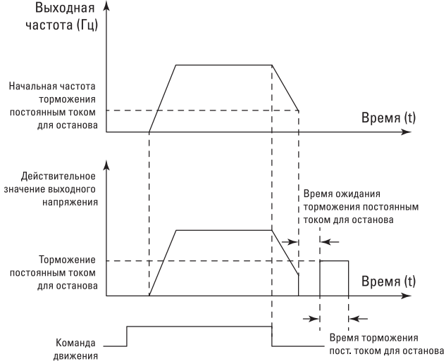
Рис. 6-13. Схема торможения постоянным током для останова
