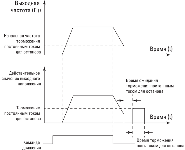
Рис. 6-13. Схема торможения постоянным током для останова
